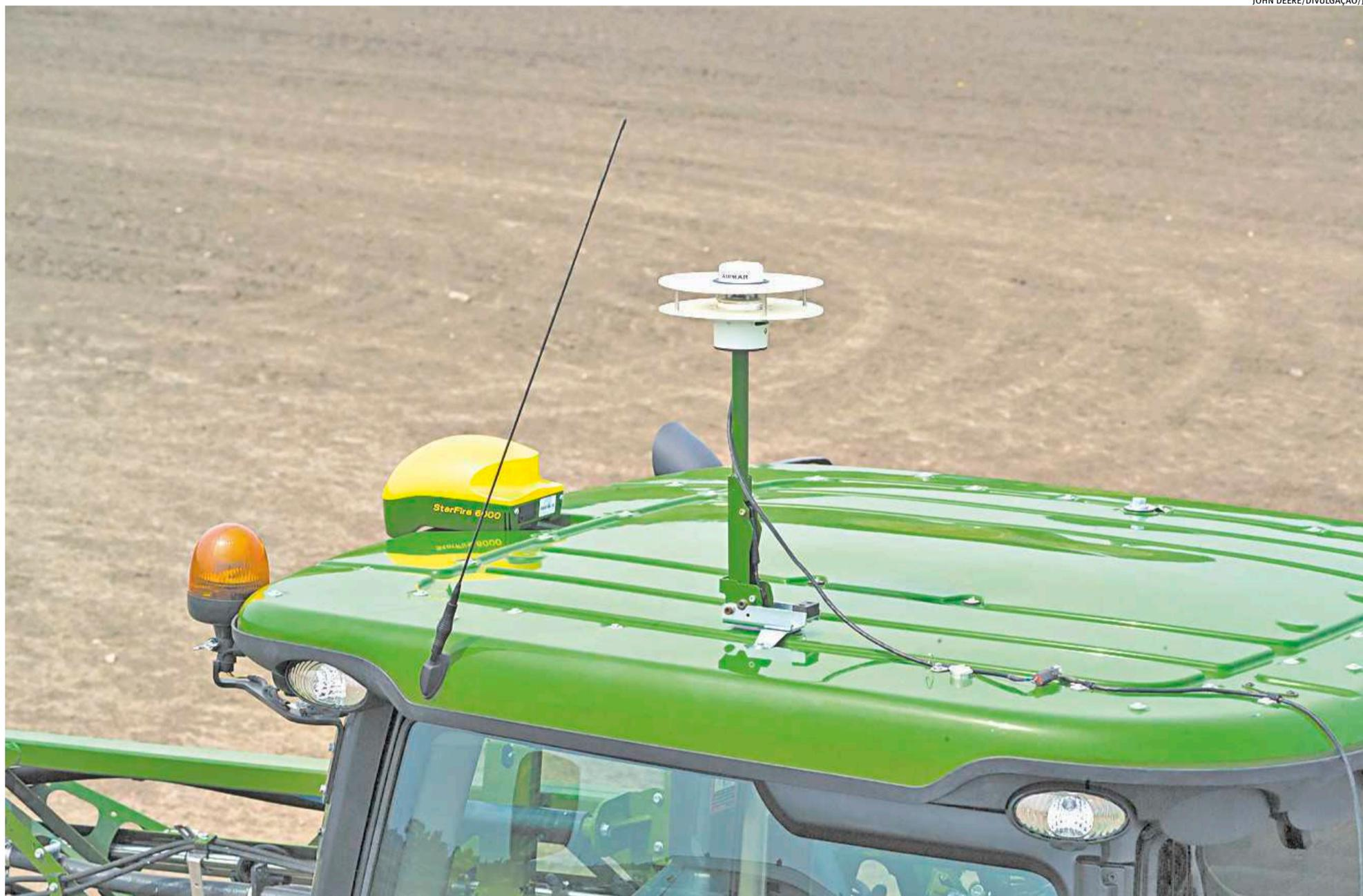
A John Deere instala uma estação meteorológica em seus pulverizadores
