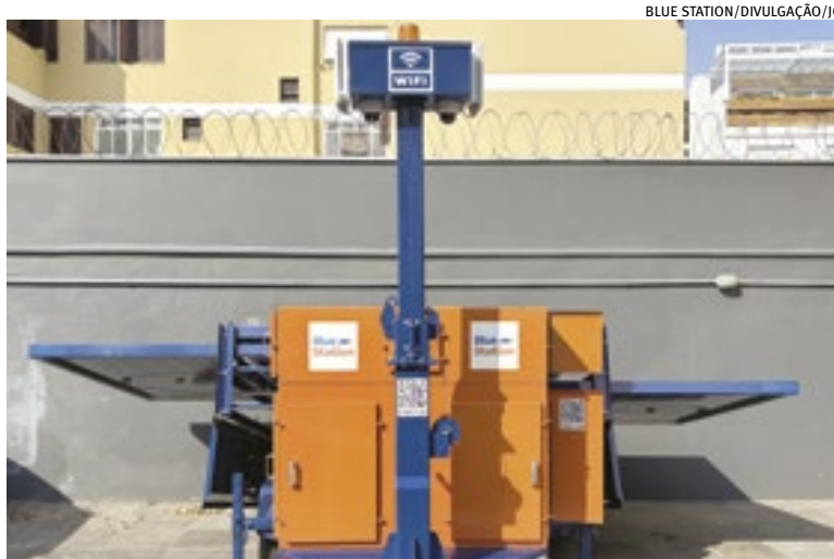
Estação oferece Wi-Fi, energia, câmeras, lâmpadas e envio de alertas
