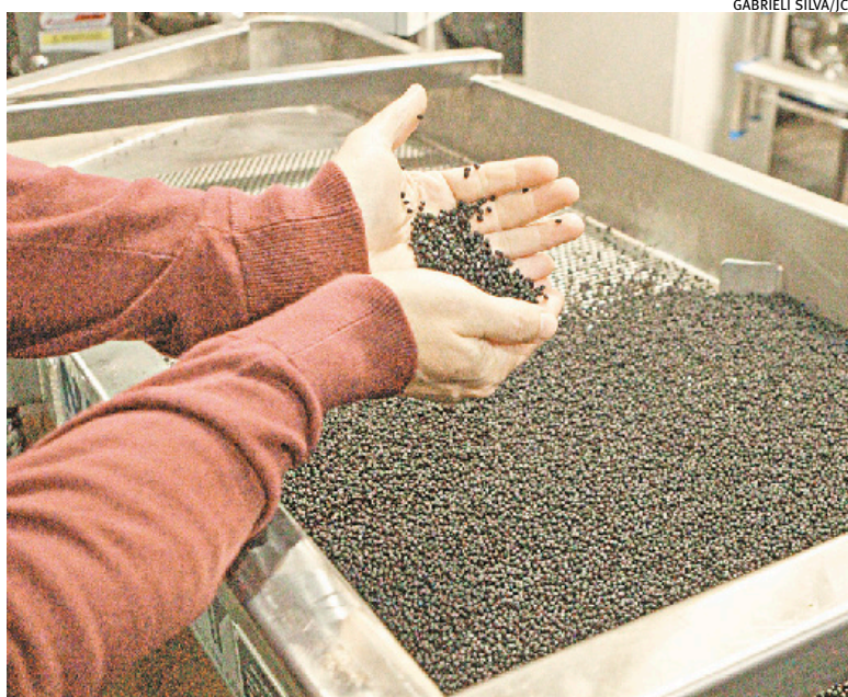
TPV fabricado pela FCC é utilizado em três elementos do Sonic
