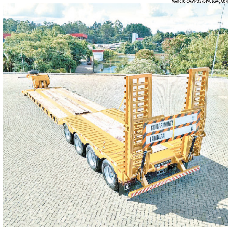
Carroceria é usada principalmente no transporte de máquinas pesadas
