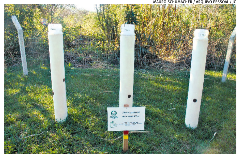
Coletor RW foi desenvolvido para captar condições do solo, da água e das plantas
