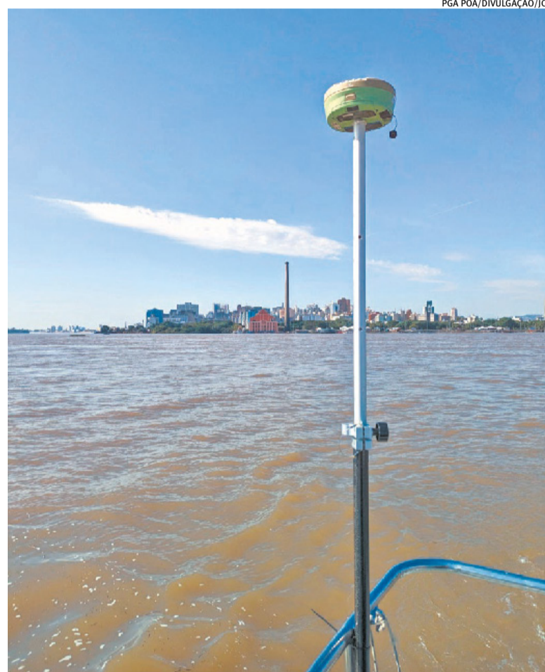
Sensores de nível junto ao porto da Capital operaram durante a cheia
